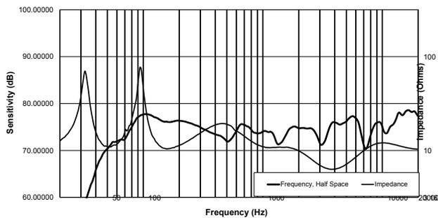
Resposta de frequência e impedância de 1 watt/4 m/no eixo (com equalização exigida pela EN54 aplicada)
